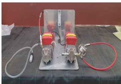
Εικόνα 1. Καινοτόμος τεχνολογία που χρησιμοποιείται τον εμπλουτισμό του νερού άρδευσης με νανοφουσαλίδες (NB)
