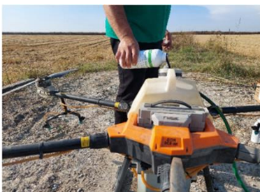
Εικόνα 2. Εισαγωγή του EMΔΕ σε drone
